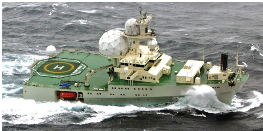
Trzecią Marjatę zbudowano w układzie ramform, który potem wykorzystano przy konstruowaniu serii jednostek do badań sejsmicznych i geofizycznych. Zdjęcie doskonale tłumaczy, dlaczego Norwegowie nazywają jednostkę żelazkiem
